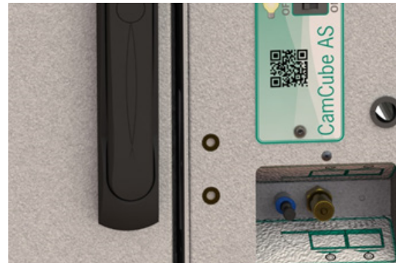
Mätuttag för tryckfallsmätning närmast serviceluckan, snabbkoppling i mässing används för läckagemätning.
